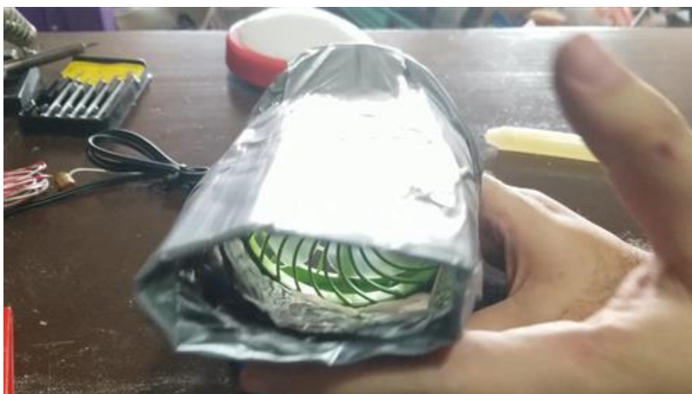
Doblar la salida para lograr más potencia.
